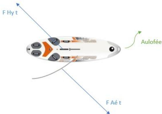
$F_{Hy t}$  n'est pas alignée à  $F_{Aé t}$  → Couple de pivotement.
